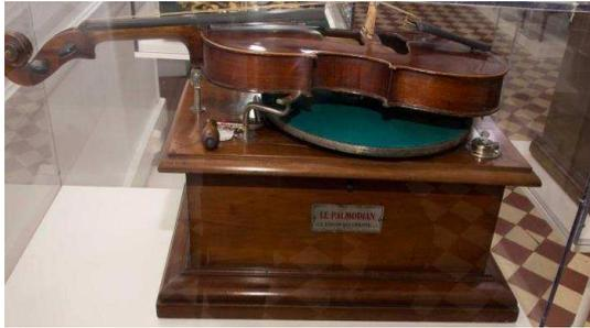
Le « Palmodian » (1913) est un appareil original car il s'agit un violon-phonographe dont le pavillon a été remplacé par un violon qui sert de caisse de résonance. Le violon peut être détaché pour être utilisé comme un instrument à part entière.
