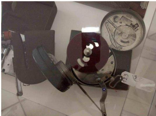
Le « Mikiphone » (1925) est le plus petit appareil de cette salle. Faisant la taille d'une boîte de camembert, c'est un appareil vraiment surprenant, car sa tête de lecture, montée sur un bras articulé, lui permet de lire des disques de toutes les tailles.
