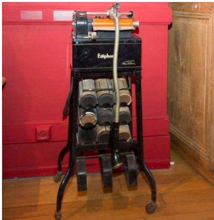
Une « machine à dicter le courrier » doublée d'une raboteuse pour effacer les cylindres de cire et d'un casier pour récupérer les déchets de cire : ce type d'appareil constitue l'ancêtre du dictaphone.
