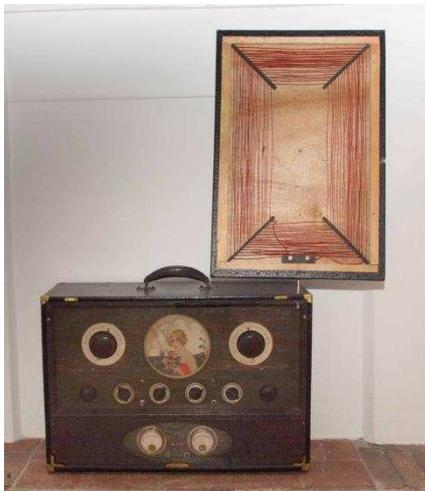
Il s'agit d'un poste « portatif » du milieu des années 1920, qui ne pèse pas moins de 10kg ! Ce type de poste captait les stations grâce à un fil ou à une antenne cadre comme celle que l'on voit ici.
