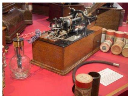
Le phonographe « Edison Classe M » date de 1888 : il est équipé d'un moteur à ressort alimenté par une pile.
